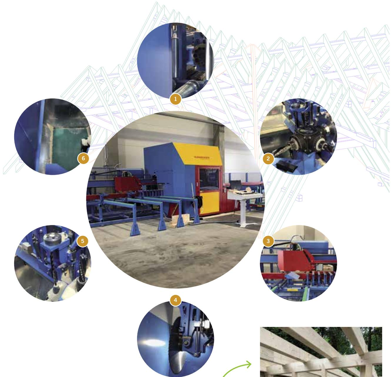
**Schritt 1:** Horizontal Bohrgeräte
