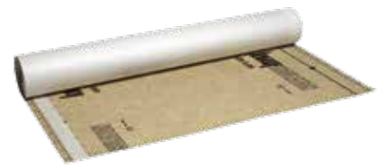
Knauf Insulation LDS 0.04 Diffusionsoffene Unterspann-/Unterdeckbahn. s_d -Wert: 0,04 m Flächengewicht: 150 g/m 2 (± 10 %)
